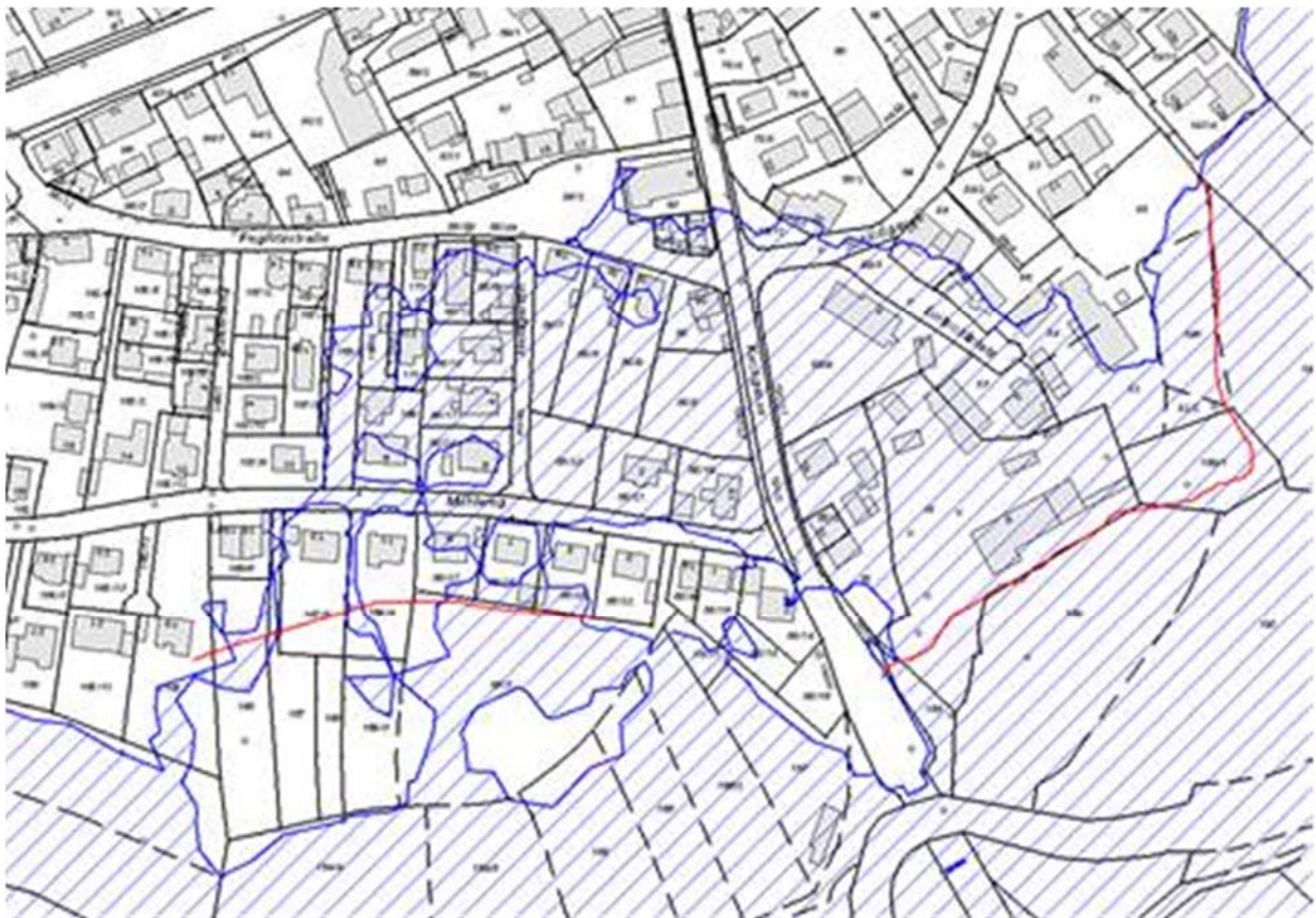
Abb. 1: Überschwemmungsbereich bei HQ100 im südlichen Ortsrandbereich von Rückersdorf (blau schaffiert), Verlauf der geplanten Hochwasserschutzmaßnahme (rote Linie); die vorliegenden Hinweise beziehen sich auf die Umsetzung des östlich der Kirchgasse liegenden Abschnitts des Hochwasserschutzes
